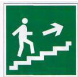
Направление к эвакуационному выходу по лестнице вверх
