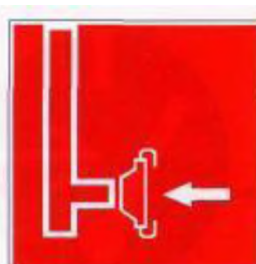
Пожарный сухотрубный стояк
