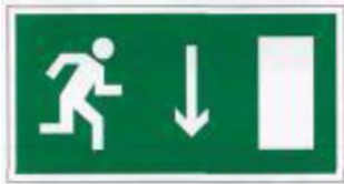
Указатель двери эвакуационного выхода (правосторонний)
